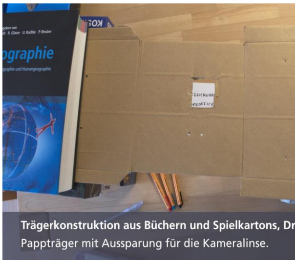
Trägerkonstruktion aus Büchern und Spielkartons, Seitenansicht. Pappträger muss fixiert werden.
